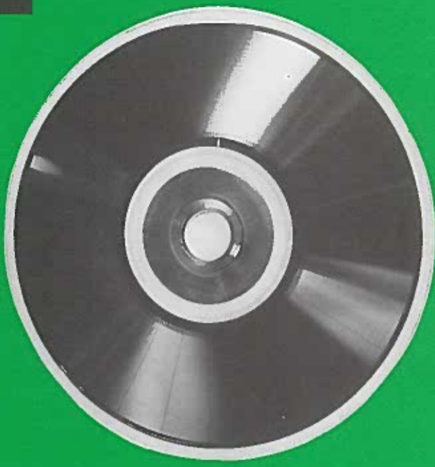
Disque d'archivage à mémoire non volatile de grande capacité, utilisé en périphérie d'ordinateur, à lecture et lecture par laser.
